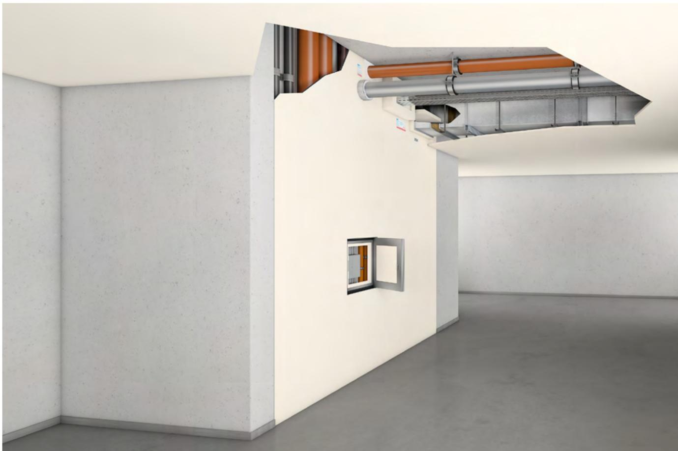
Leitungsanlagen zur Ver- und Entsorgung werden bei vertikaler Verlegung in Gebäuden häufig in sogenannten Installationsschächten zusammengefasst.
