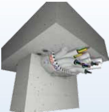
**ΩMEGA-Anwendung - Elektro Mehrfachbelegung in Massivwand**
