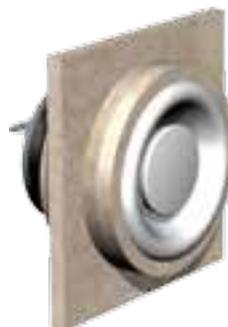
Die PREMIO Einbaugehäuse für Lüftungsgitter & Tellerventile werden aus Gipsfaserplatten entsprechend der benötigten Beplankungsart- und -dicke der Wand oder Decke gefertigt. Der überlappende Einbaurahmen gewährleistet eine rißfreie Oberfläche und ermöglicht einen einfachen und schnellen Einbau. Im luftseitigen Anschlussstutzen kann optional eine Kaltrauchsperrn eingesetzt werden.
