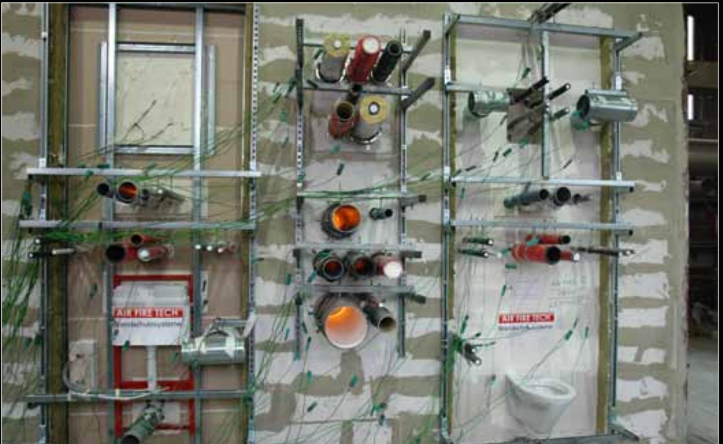
Brandschutzprüfung nach europäischem Standard inkl. WC-Unterputzspülkasten eingebaut in Schachtwand.
