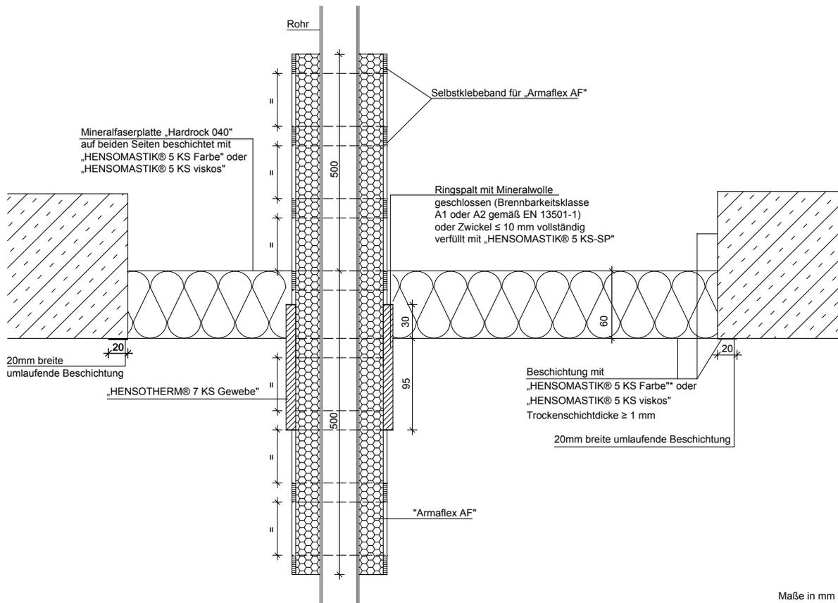
\* Das Rohr und die Isolierung müssen in der Mitte der Rockwool Platte mit einer Lage HENSOTHERM®7 KS Gewebe von 125 mm Länge umwickelt sein. Die Streifen liegen 95 mm außerhalb der Abschottung. Die einzelne Lage der Bandage ist mit 10 mm zu überlappen. Das Gewebe ist mit Rödeldraht  $d \geq 6$  mm zu fixieren.
