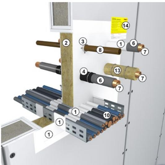
**HENSOMASTIK® Kombi-Weichschott-Systeme** werden als Abschottungen für Metallrohre, brennbare Rohre und elektrische Leitungen eingesetzt, um die Brandsicherheit von Wand- und Bodenkonstruktionen wiederherzustellen, die mit Öffnungen für Versorgungsleitungen versehen sind.
