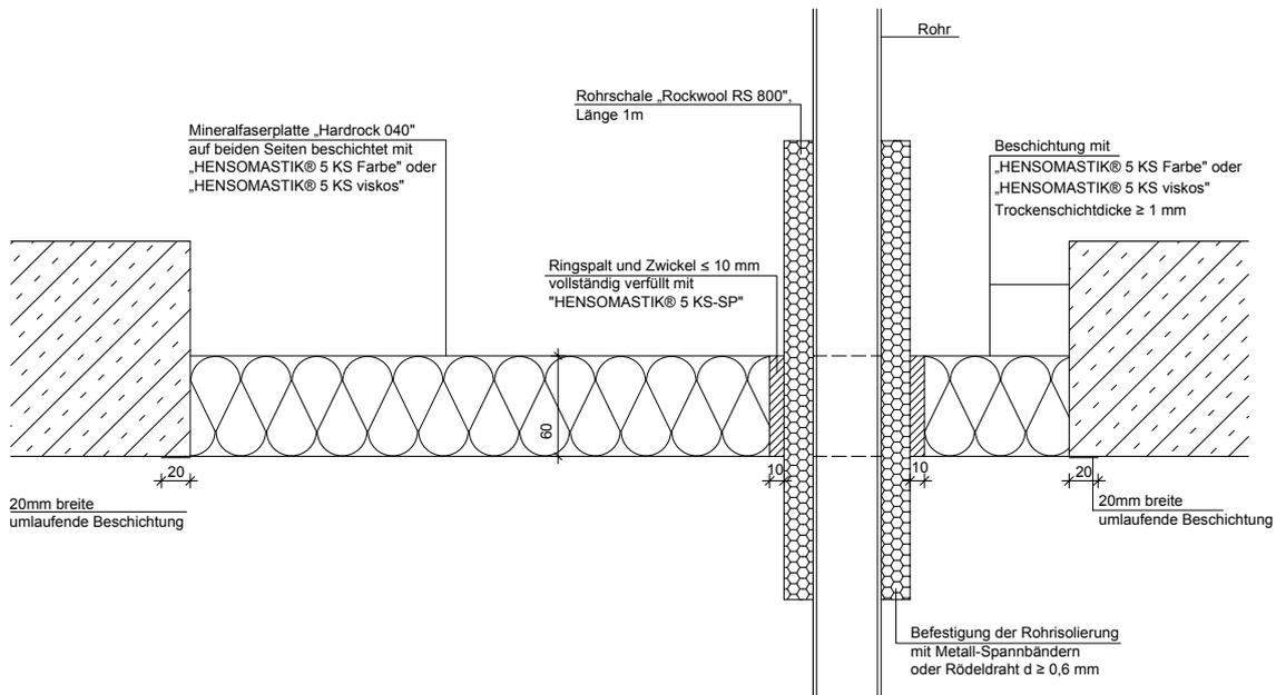
Die Länge der Streckenisolierung darf vergrößert, aber nicht reduziert werden.
