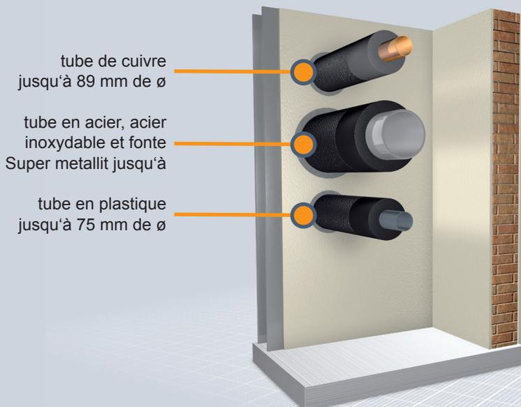
Grâce à son action intumescente en cas d'incendie, le nouvel Armaflex Protect assure une isolation hermétique fiable des conduites en cuivre, en acier, en inox et en fonte Super metallit, mais également des conduites d'alimentation inflammables comme les conduites multicouches en plastique, PE, PEHD, PP ou PVC.
