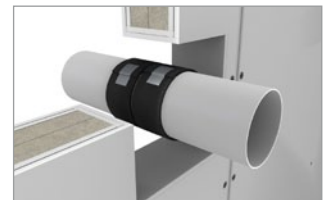
Fertige Wicklung mit Gewebeband fixieren
