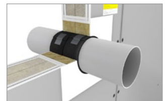
Kennzeichnung der fertigen Abschottung
