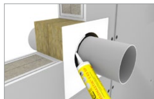
Verschließen des Ringspalts mit HENSOMASTIK® 5 KS SP
